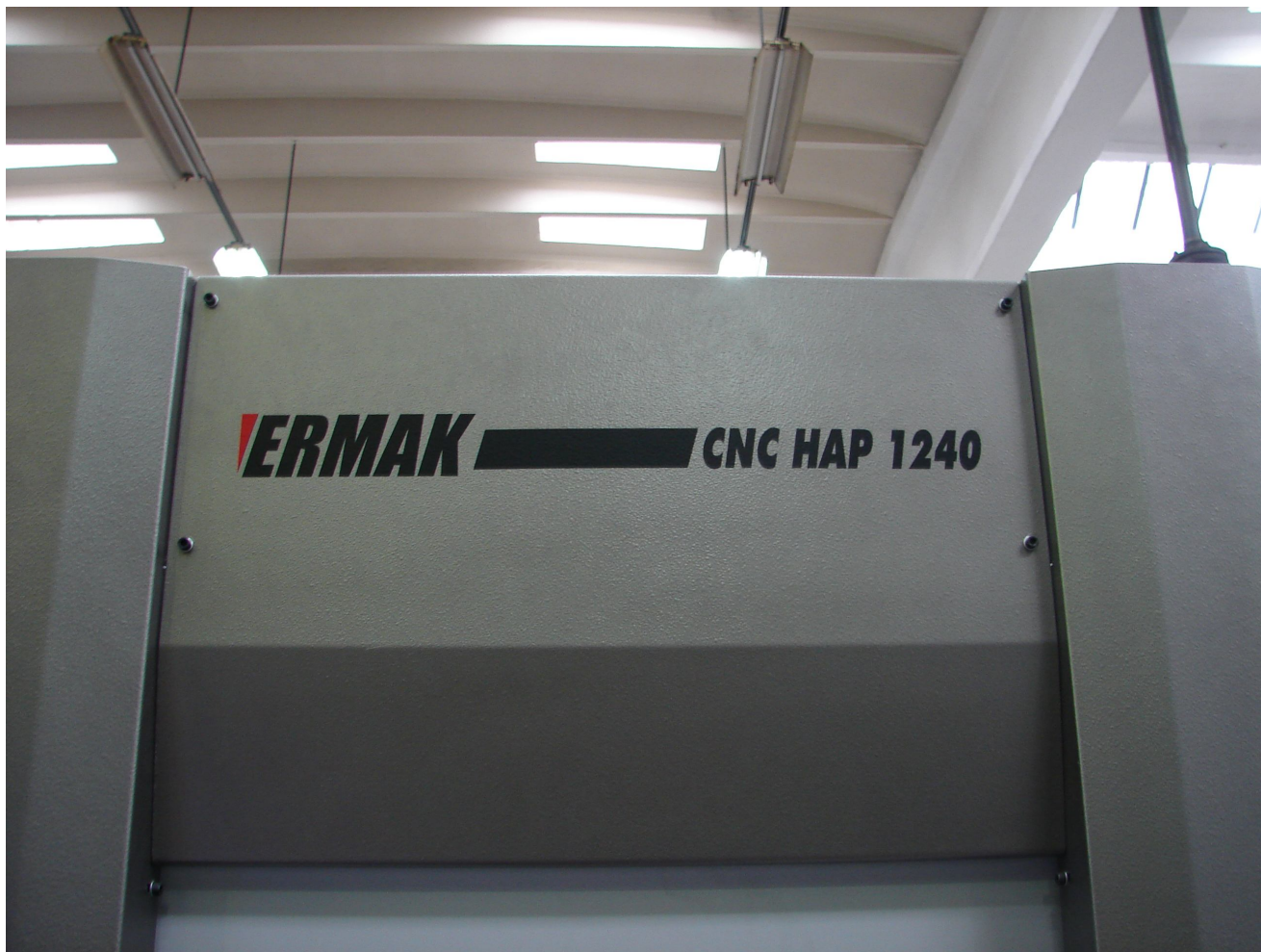
Fotografia nr.1 Presa abkant de îndoit tablă. Stickul frontal amplasat greșit CNC HAP 1240 în loc de CNC HAP 1270.
